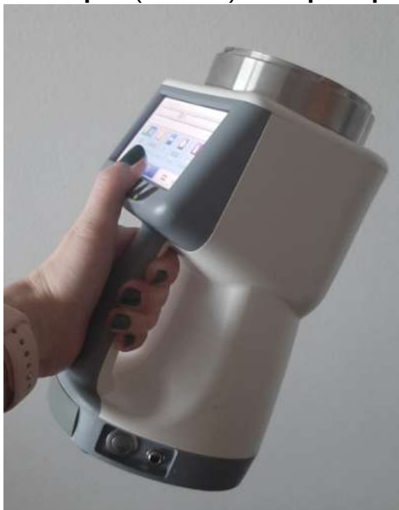
Obr. č. 11 – Nasávání vzduchu aeroskopem
