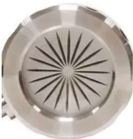
Obr. č. 2 – Impaktor aeroskopu s viditelnou „hvězdicí“
