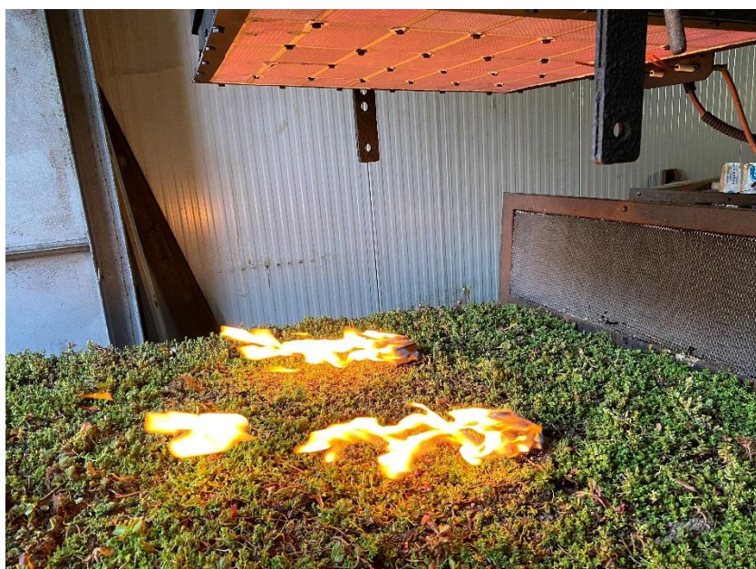
Obrázek 22 Požární zkouška vegetační střechy - PAVUS Veselí nad Lužnicí
