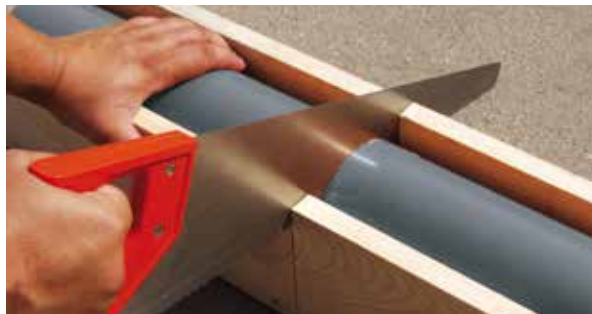
Obrázek 2 Úkos dodatečně zkrácené trubky
